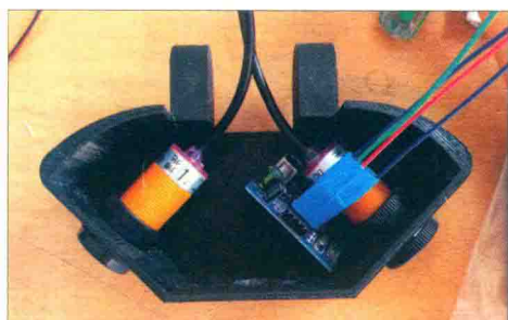
■ 图 18.15 将传感器安装到适当位置，中路为超声波传感器，左、右为红外避障传感器
