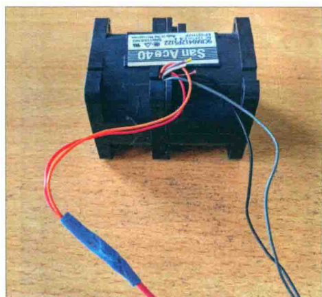
■ 图 7.4 将红色线、橙色线合并为正极线，将黑色线、灰色线合并为负极线
