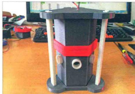
■ 图 7.24 安装灯带灯槽和顶座
