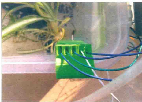
■ 图 13.5 安装水位传感器后的样子
