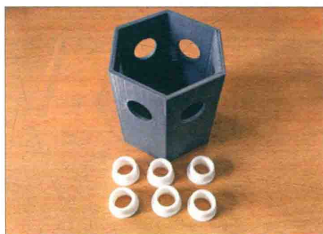
■ 图 7.13 冰槽及出风口实物
