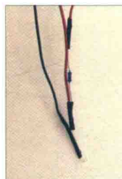
图 20.9 用热缩管将所有焊接的地方包裹住
