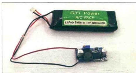
■ 图 4.4 将电池与升压模块连接起来
