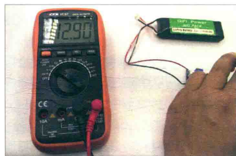
■ 图 4.5 通过调整升压模块上的旋钮，将电压升至 12V
